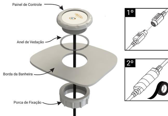
Para instalação do Painel de Controle proceda conforme a figura acima. Faça um furo na borda da banheira com uma serra copo de **Ø46 mm**, remova as rebarbas, insira o cabo, o painel de controle e o anel de vedação, rosqueie a porca de fixação, verifique o perfeito assentamento do anel de vedação. Para finalizar, conecte o painel a unidade de potência e proteja a união dos conectores com fita isolante, conforme indicado acima.
